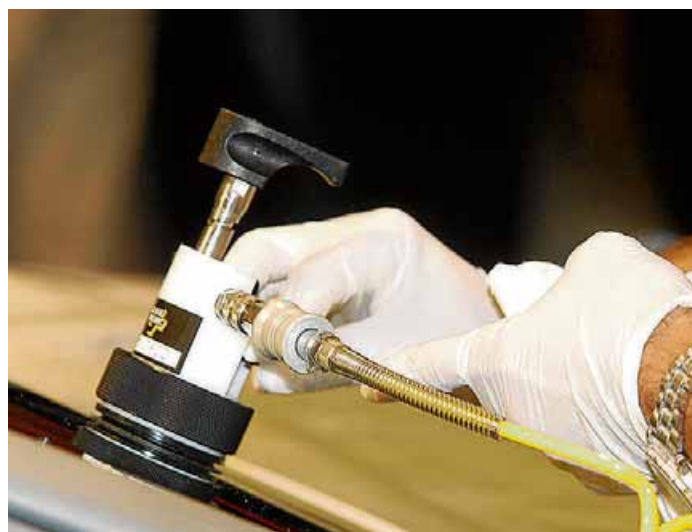
Bomba de vácuo é utilizada para preencher a trinca com resina
