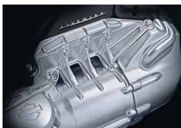
Coração. Motor é montado na posição transversal
