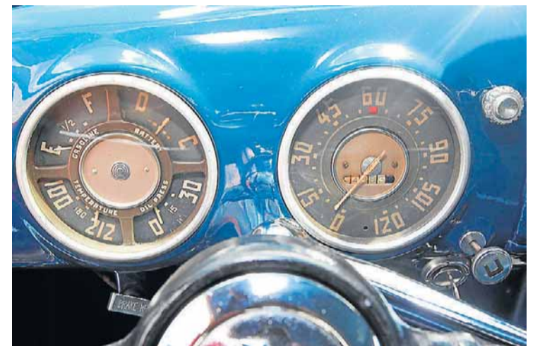
Painel. Há indicadores do nível de óleo e da carga da bateria
